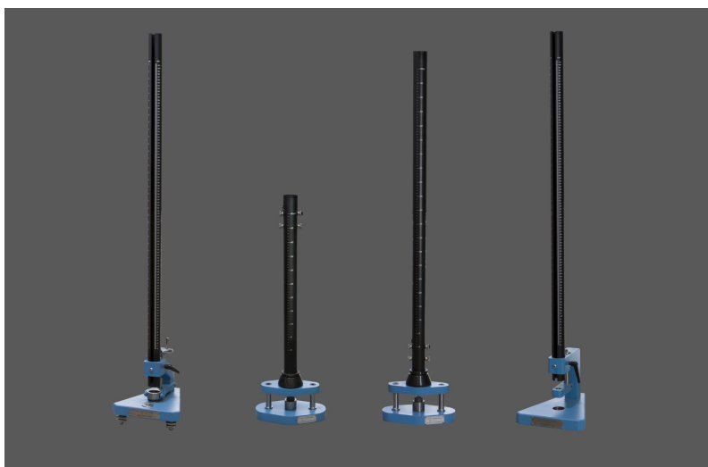
弹性冲击器、漆膜冲击器（0.5m）、漆膜冲击器（1m）重型冲击器（从左至右顺序）
