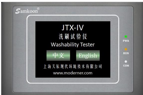
JTX-V型（耐洗刷、耐污渍二用型）是对涂刷于标准试板上的涂料进行洗刷试验，洗刷次数可由触摸屏控制并读出。根据耐洗刷次数的多少来评定涂层耐洗刷性能，根据洗刷前后的对比来评定涂层耐污渍性能。
